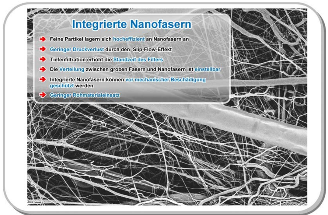
Bild 3: REM-Aufnahme: Integrierte Nanofasern
